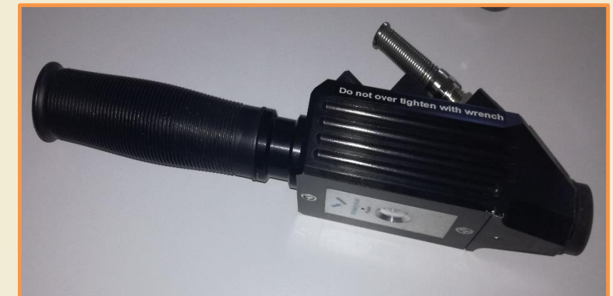
Fig. 5. Espectroradiómetro conectado a la sonda de contacto ASD
