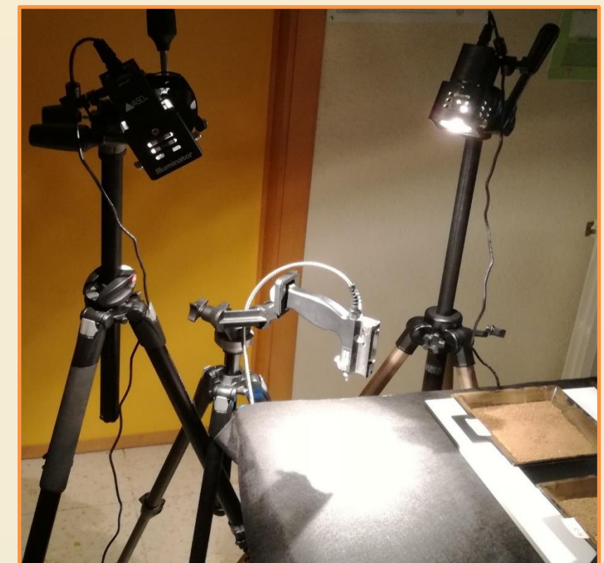
Fig. 4. Espectroradiómetro conectado a la fibra óptica de captura de datos
