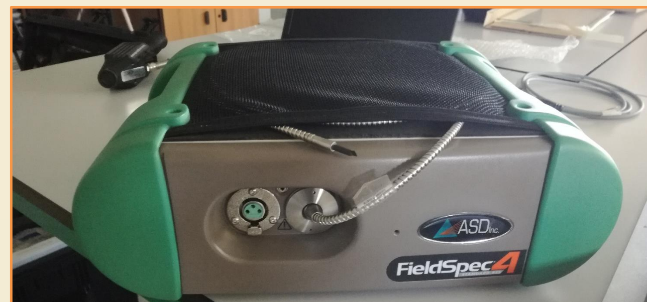
Fig. 3. Espectroradiómetro portátil de campo ASD FieldSpec 4 Standard-Res
