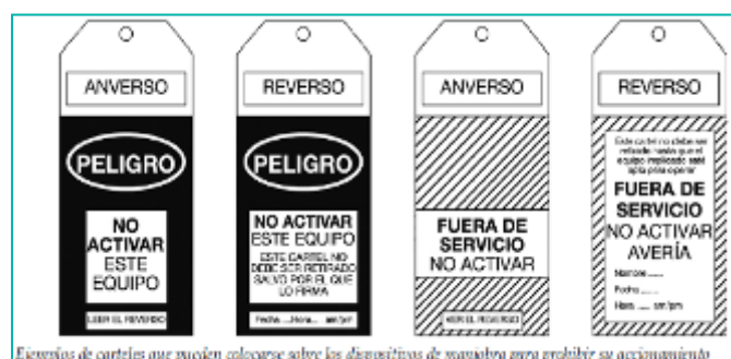
Ejemplos de carteis que púcan colocarse sobre los dispositivos de manobra para prohibir su acción
