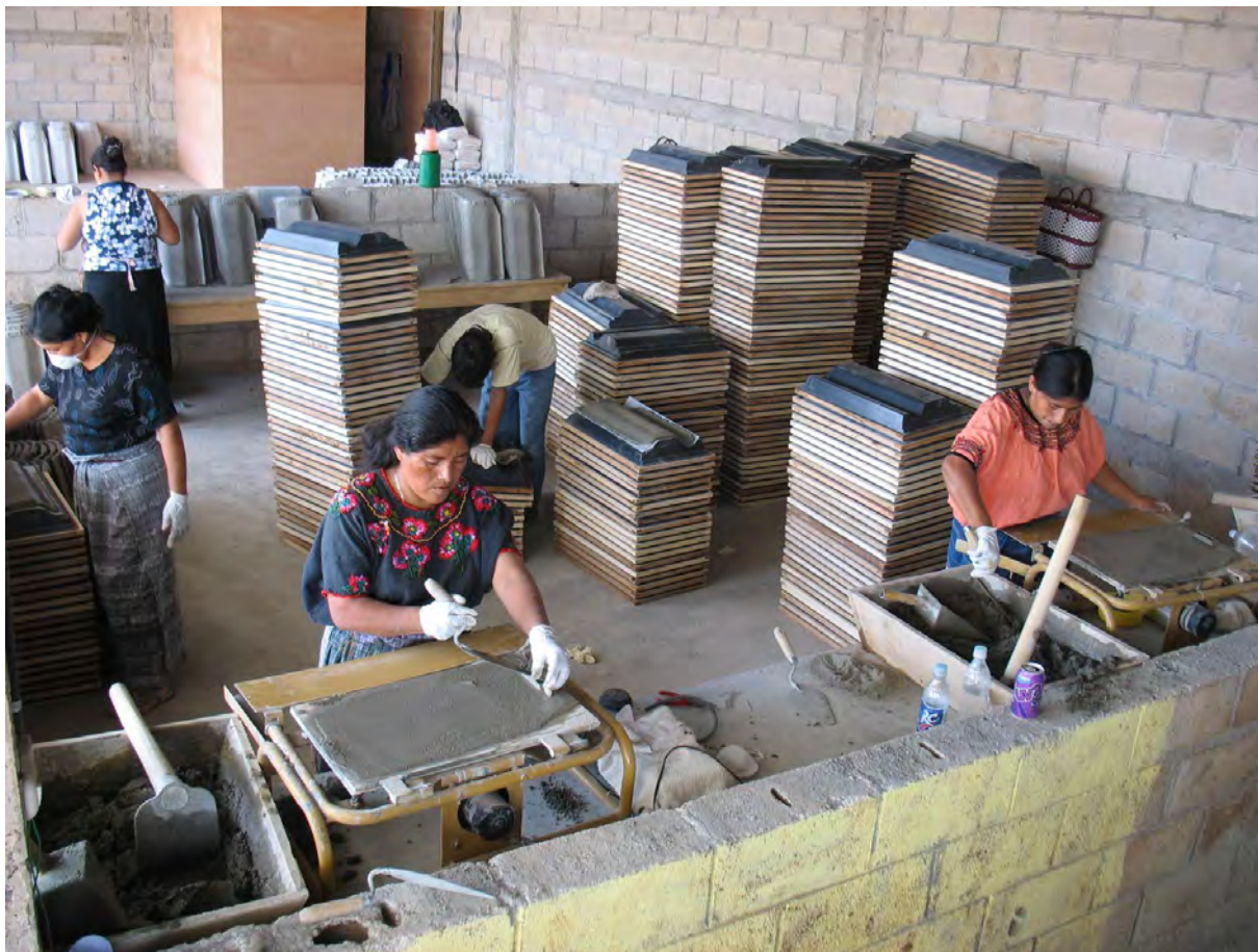
Operarias manejando las vibradoras sobre las mesas. Planta de fabricación ASF-ASIAPRODI, Programa Oxlajuj Tz'ikin
