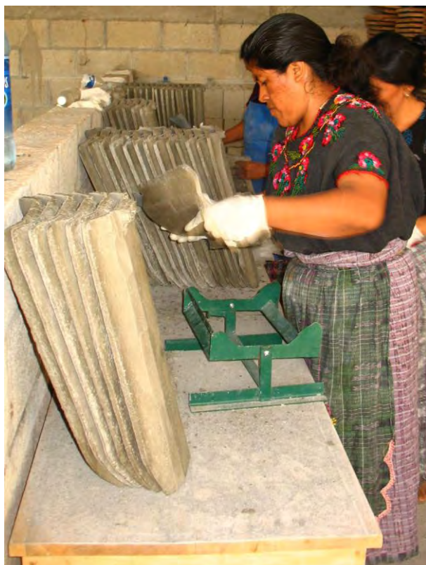
Operaria utilizando la guía de verificación
