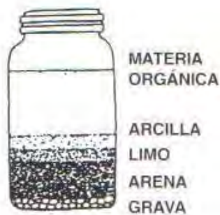
Resultado de la prueba de sedimentación realizada con tierra extraída en la comunidad María del Mar, Champerico, Reatlhuleu, Guatemala
