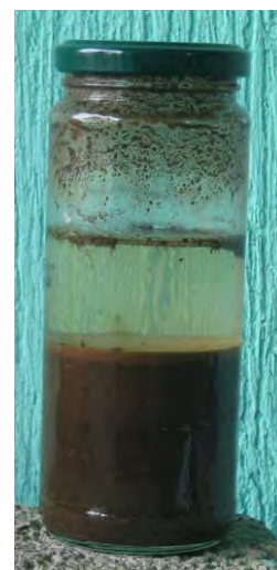
Resultado de la prueba de sedimentación realizada con tierra extraída en la comunidad María del Mar, Champerico, Reatlhuleu, Guatemala
