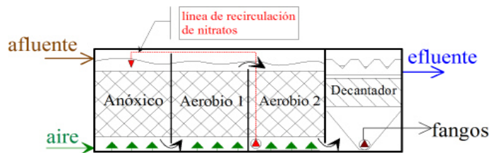
Figura 1. Proceso de lecho aireable sumergido (LAS-NITRO)
