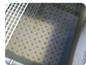
Relleno cubierto de biopelícula
