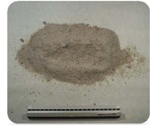
Muestra de material residual de la perforación sobre roca sana
