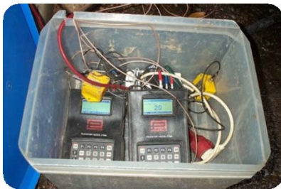
Caudalímetros Panametrics PT 868 instalados en tubería y TinyTag para almacenamiento datos
