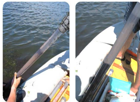
Agua de toma de columna de sedimento, esta se desmontaba del dispositivo de hincia y se confinaba el sedimento y el agua mediante tapones en ambos extremos
