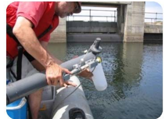
Toma de muestras en columna de agua mediante muestreador de Botella Niskin.
