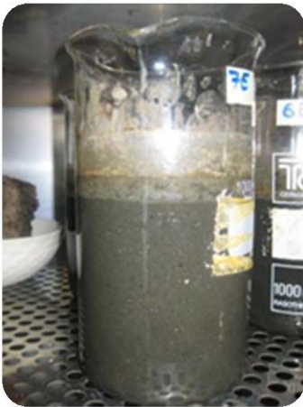
Estado inicial de las muestras al comienzo del proceso de secado en la estufa a 105 °C.
