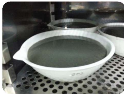
Estado inicial de las muestras al comienzo del proceso de secado en la estufa a 105 °C.
