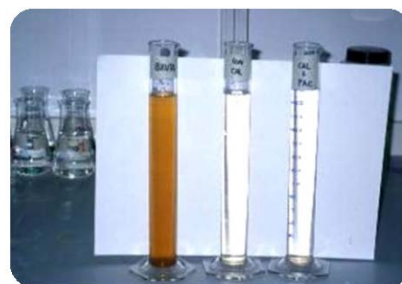
Izq a derch: Lixiviado bruto, tras precipitación con cal y tras precipitación con cal más adsorción con carbón activo en polvo.
