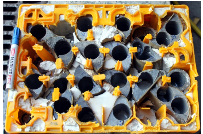
A: Obtención de probetas ( subcoring ) a partir de una serie de mitades de testigo de 4" de diámetro ( full cores )
