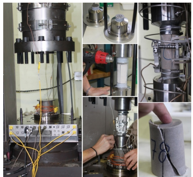
C: Secuencia de preparación de una probeta para ser ensayada bajo condiciones de confinamiento triaxial con extensometría in vessel
