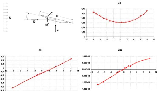
A continuación se determinaron las funciones de flameo, las cuales permiten obtener la velocidad crítica de flameo de la estructura empleando la metodología híbrida. Se ha obtenido una velocidad crítica de flameo muy superior a los valores de viento esperables en la zona.
