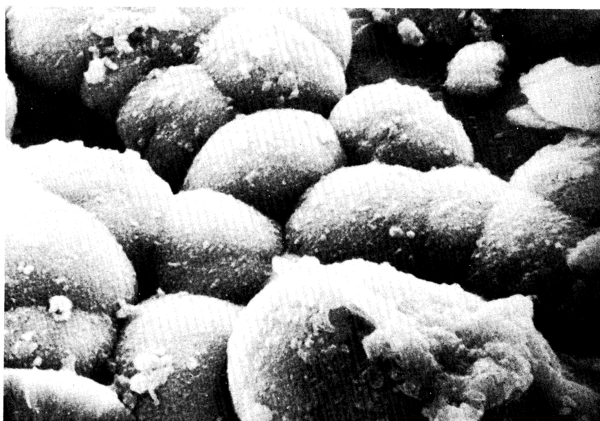
Foto 2 Muestra R-TMC. Recubrimientos discontinuos en una separación tubular (3.500 x).
