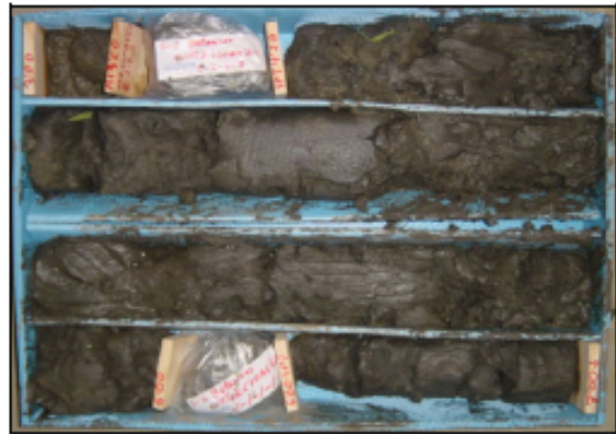
Foto 3: Sondeo S1 de 3,00 m a 7,00 m.
