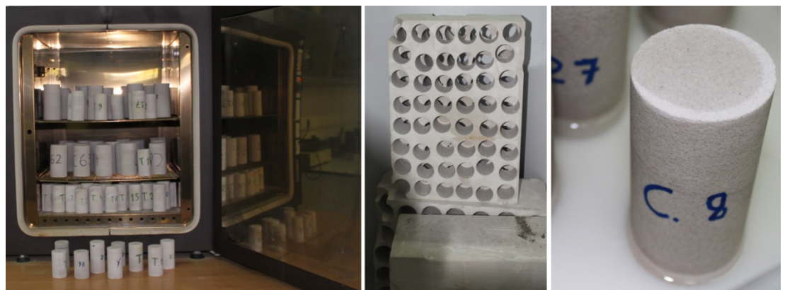
C: Algunas de las probetas obtenidas para la caracterización exhaustiva de la Arenisca de Corvio (izquierda y centro). A la derecha, saturación por ascenso capilar de una probeta
